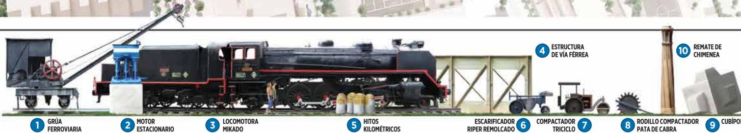
1 GRÚA FERROVIARIA 2 MOTOR ESTACIONARIO 3 LOCOMOTORA MIKADO 4 ESTRUCTURA DE VÍA FÉRREA 5 HITOS KILOMÉTRICOS 6 ESCARIFICADOR RIPER REMOLCADO 7 COMPACTADOR TRICICLO 8 RODILLO COMPACTADOR PATA DE CABRA 9 CUBIPODO 10 REMATE DE CHIMENEA
